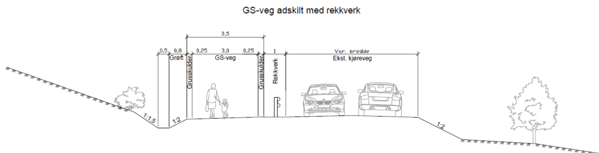
Figur 14 Normalprofil gang- og sykkelveg med rekkverk
