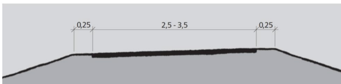
Figur 17. Tverrprofil for gang- og sykkelveg. Kilde: Håndbok N100, Statens vegvesen
