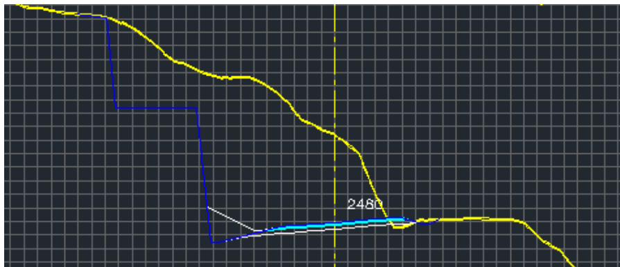
Figur 29: Skisse som viser vegen liggende i skjæring med palle
