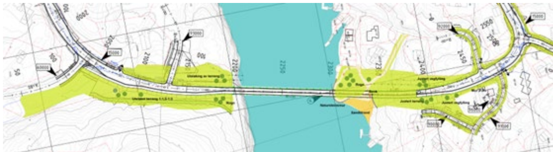
Figur 29: Med en god terrengtilpassing, vegetasjonsetablering samt bygging av en ny naturlig strandpark integreres det nye veganlegget relativt godt i landskapet.
