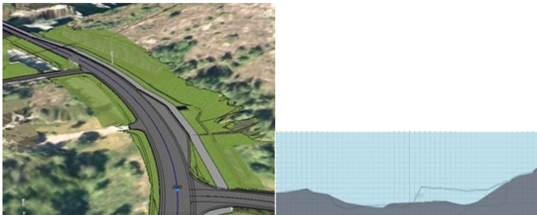
Figur 22: Bergskjeringer skal dekket med magre løsmasser med helning 1:1,5 -1:3 og tilsåst med stedtilpasset frøblanding.
