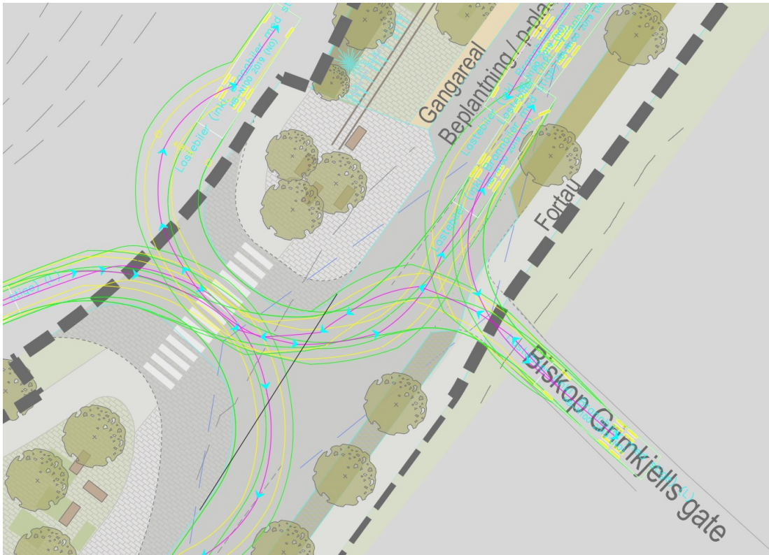
Sporinger for lastebil inn/ut av Biskop Grimkjells gate
