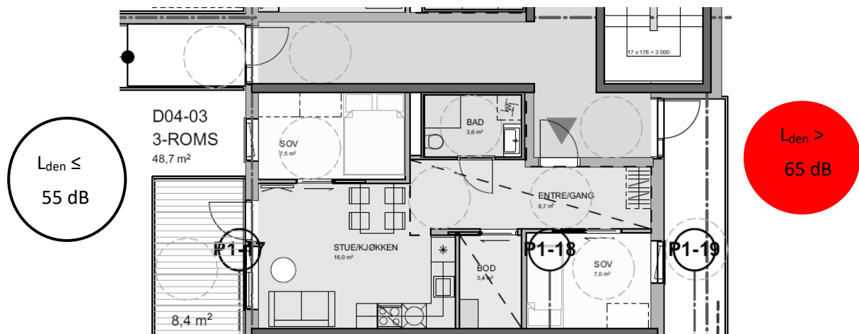
Figur 9 - Eksempel på planløsning som tilfredsstiller foreslåtte krav til støyutsatt enhet.
