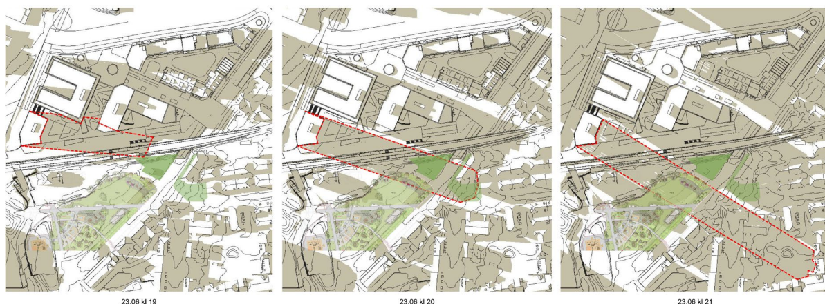
Figur 5.3.4 Høyhusets skyggevirkning på omgivelsene
