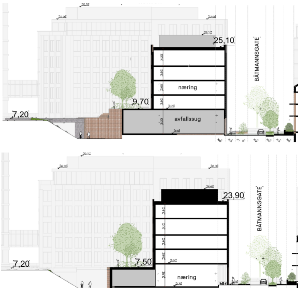
Snitt fra jernbaneperrong til Båtmannsgata med terminal for avfallssug vist øverst og snitt uten terminal for avfallssug vist nederst. Kotetall for meter over havet fremgår i illustrasjonen.
