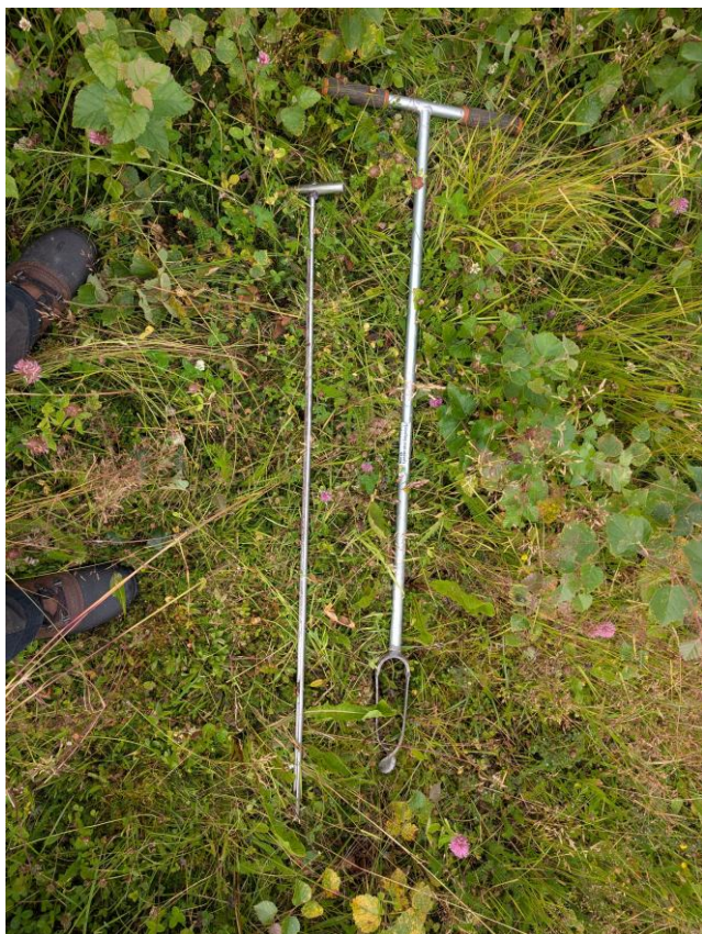
Bilde: Boniteringsbor (venstre) og skovelbor (høyre) var med på befaringen. Tykkelse på jordlaget ble vurdert med boniteringsboret.
