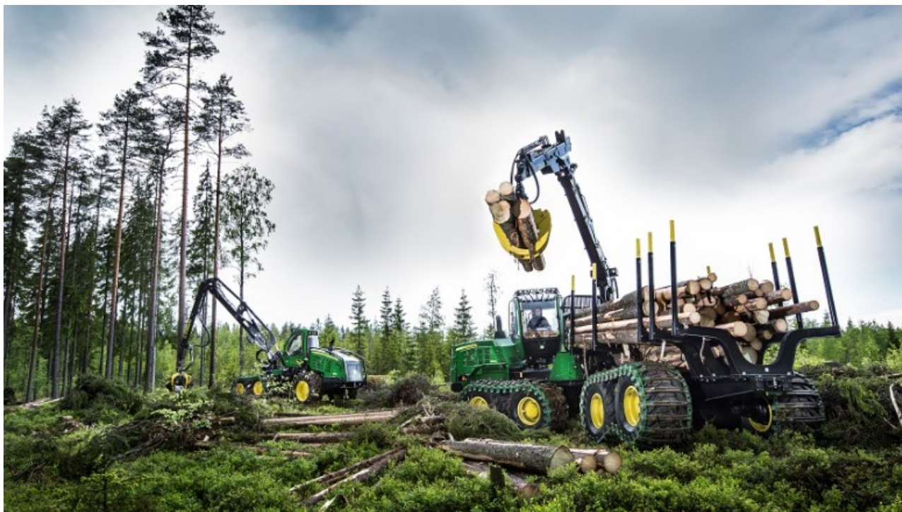
Figur 5: Hogstmaskin og lassbærer i gang med hogst og transport. Kilde: Kystskogbruket.no. 11
