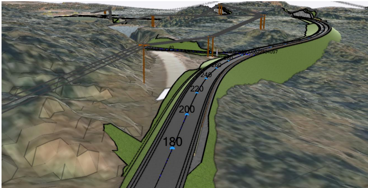
Figur 4-3 Ny veg på fylling ved Jektvikmyra, sett i retning nordvest mot Jøa. Ny avkjørsel mot Ølhammarbukta midt i bildet (Kilde: Norconsult).
