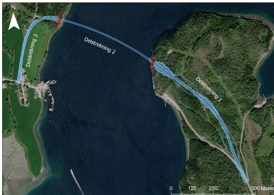
Figur 1-1 Delstrekninger for planlagt ny fylkesveg 777 Elvalandet - Jøa
