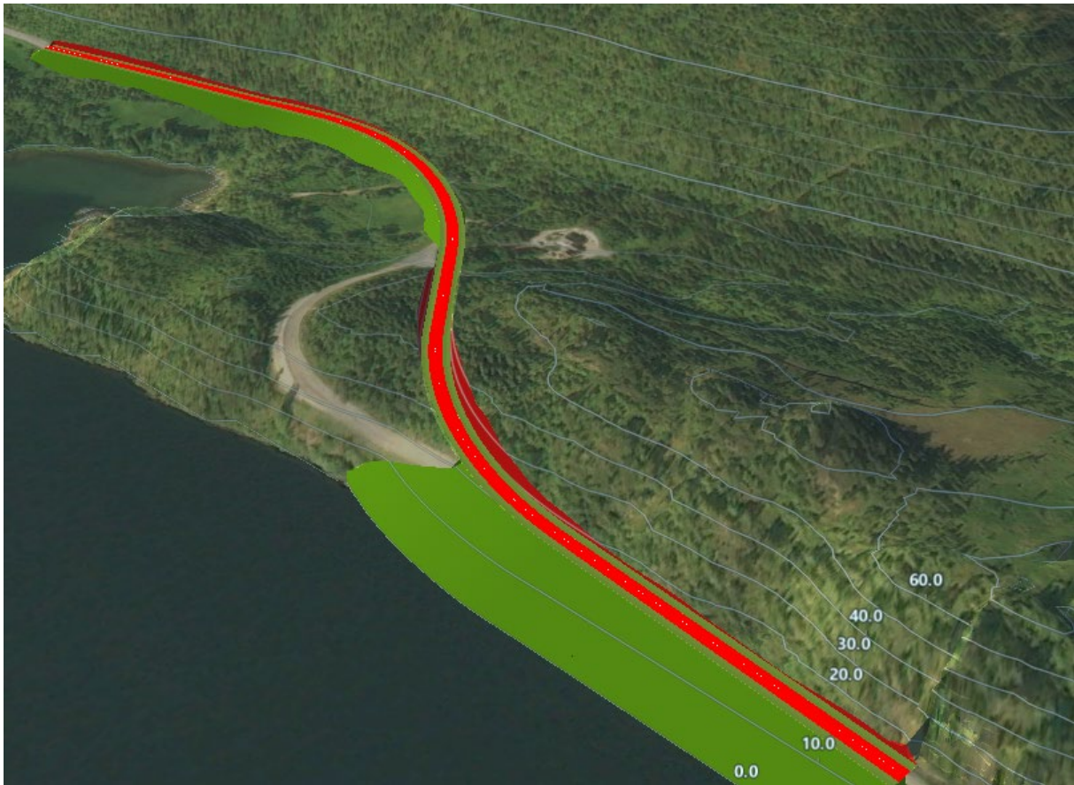
Brevikbukta – utbedring av kurve
