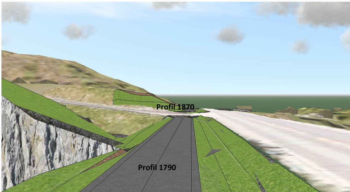
Figur 44: Utsnittet viser gang- og sykkelvegen mellom profil 1790 og 1870, der Torsengdalen er gjenfylt
