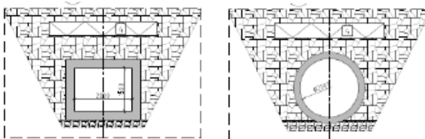
Figur 58: Omylling av rør/kulvert
