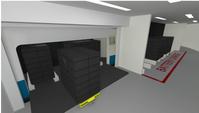
Bilde 6-4: Batteribytte: utkjøring av batterier
