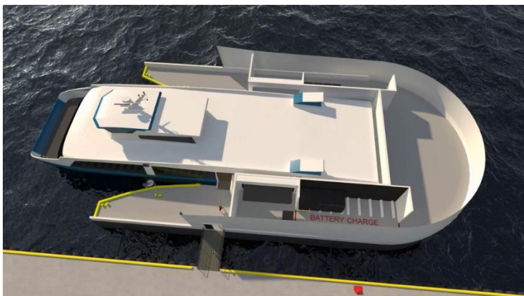
Bilde 6-3: Batteribytte: adskilte områder batteribytte og passasjerer
