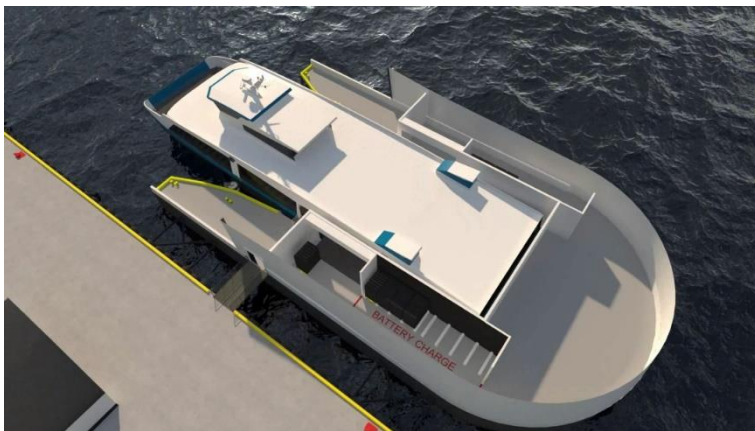
Bilde 6-2: Batteribytte: automatisk posisjonering
