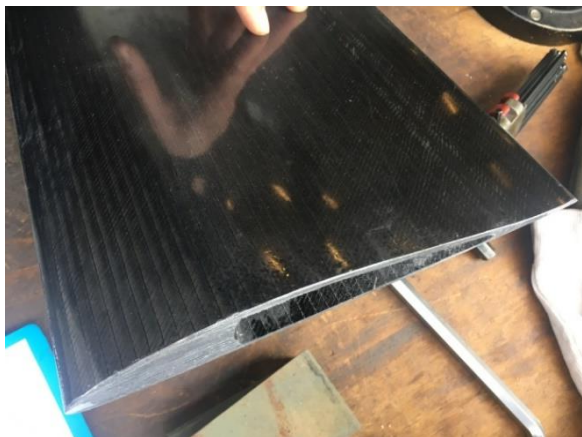
Figur 5 Vingeprofilen til testfoilene
