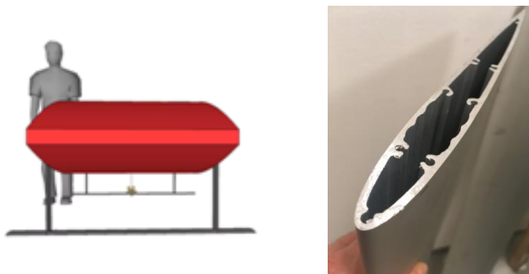
Figur 8 Tidlig modell og testfoilenes vingeprofil
