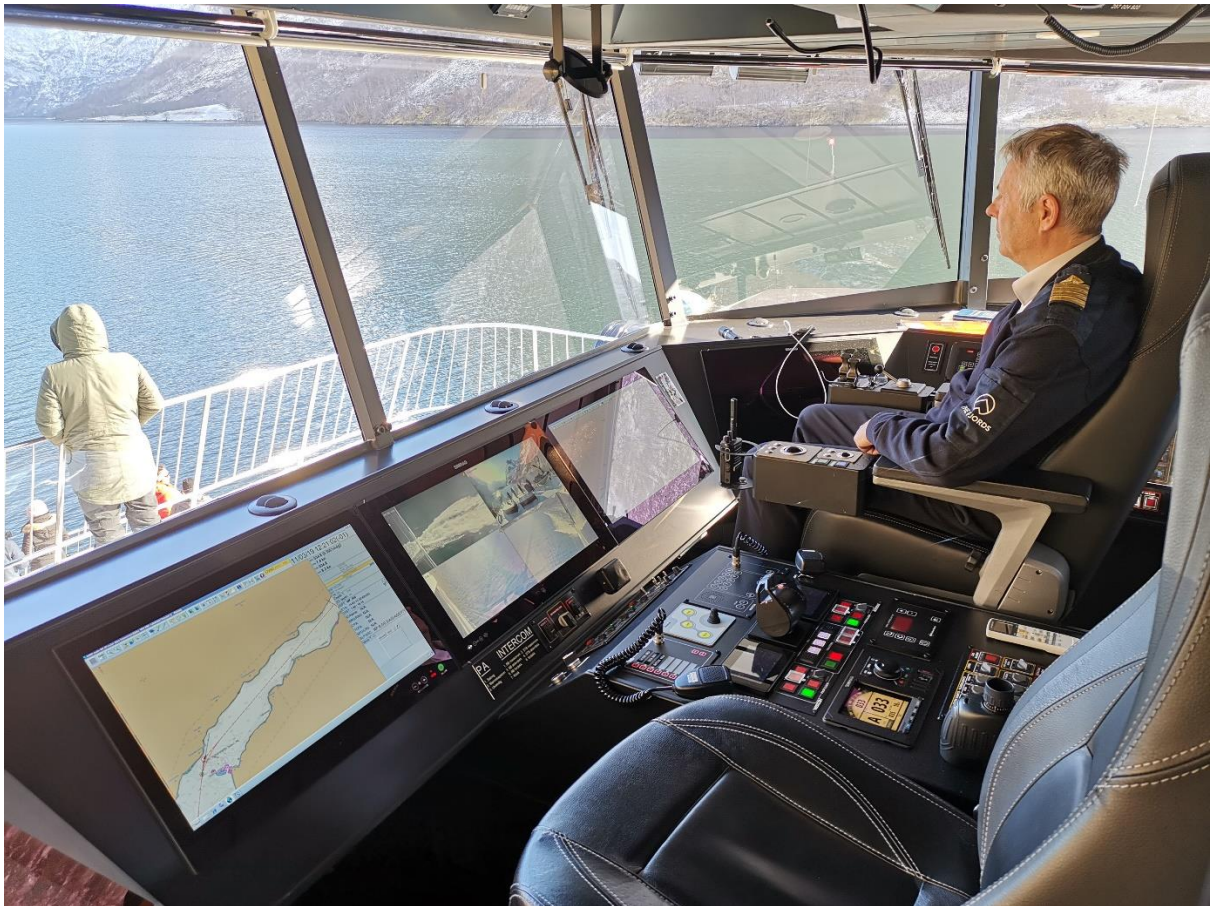
Foto 5. Energi- og fremdriftssystemet på «Future of The Fjords» er i stor grad automatisert. Overvåking, kontroll og eventuell overstyring skjer fra styreposisjonen på broa. Foto: Lars Haugnes
