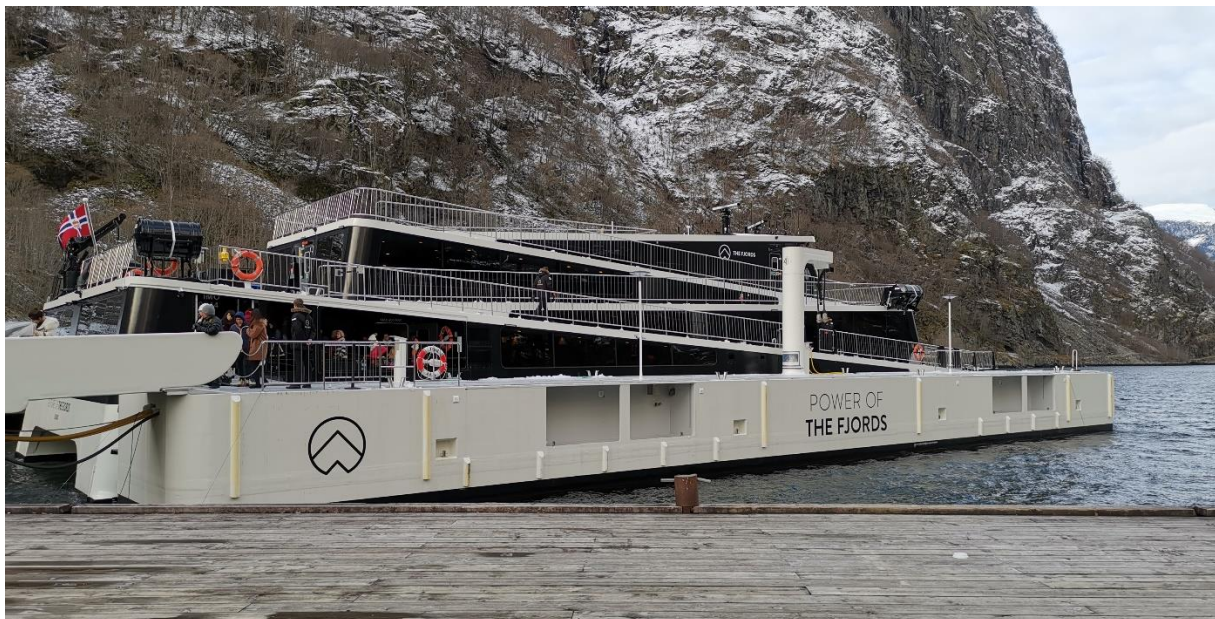
Figur 5 og foto 3. Brødrene Aa og Westcon Power & Automation sitt nytviklede konsept PowerDock løser utfordringen for lading når nettet på land har lav kapasitet. Illustrasjonen øverst viser prinsippskisse av konseptet. Foto nederst viser PowerDock'en i bruk av «Future of The Fjords». Figur: Brødrene Aa. Foto: Lars Haugnes
