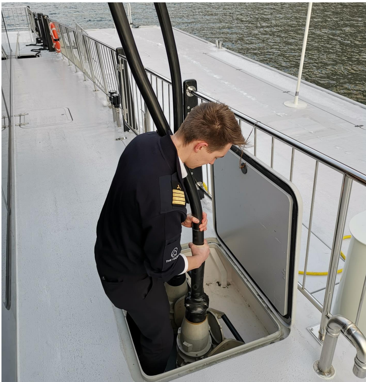
Foto 4. Tilkobling av ladeplugg på «Future of The Fjords». Det brukes to plugger til lading av batteripakkene. Hver plugg kan lade med 1,2 MW effekt. Foto: Severin Synnevåg
