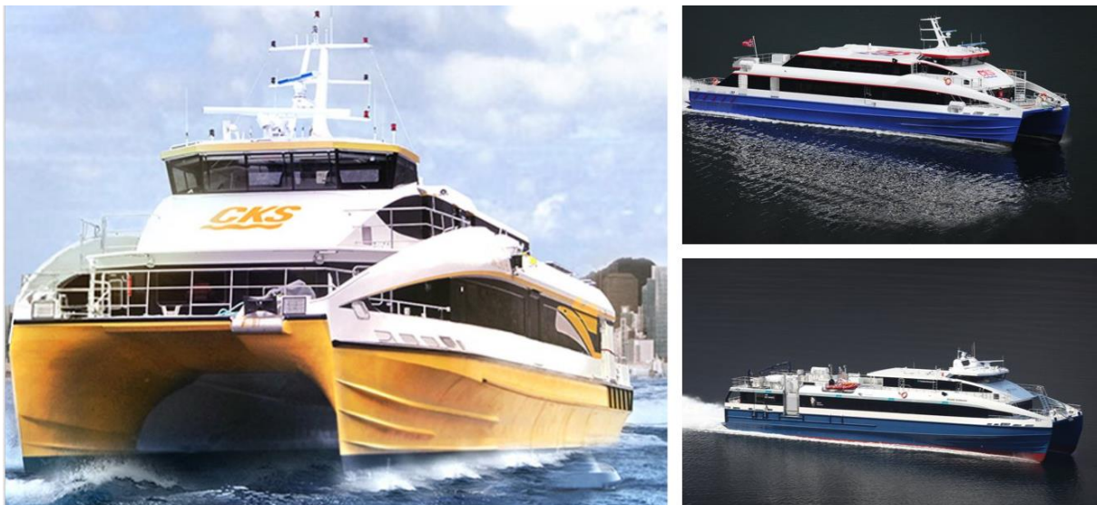
Illustrasjon 33. Eksempel på tre av Brødrene Aa sine karbonfiberfartøy med skjærende katamaranskrog. Fartøyene har 40-42 meters skroglengde og fart 35-42 knop
