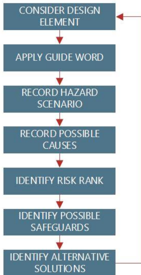
Illustrasjon 35. Metodikk for analyse ved gjennomføring av HAZID
