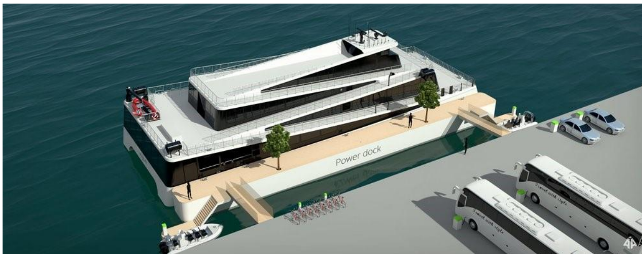
Illustrasjon 21. Brødrene Aa og Westcon Power & Automation sitt konsept PowerDock løser utfordring med lading når nettet på land har lav kapasitet 40
