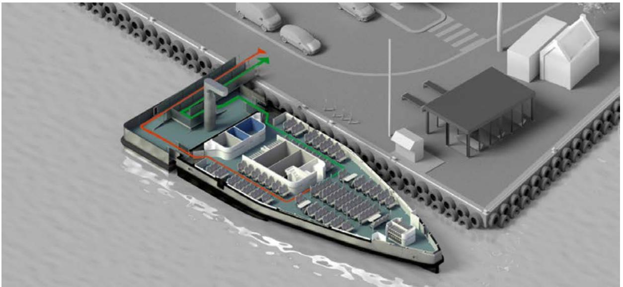
Figur 10: Sideanløp via flytebrygge med separat av/påstigning
