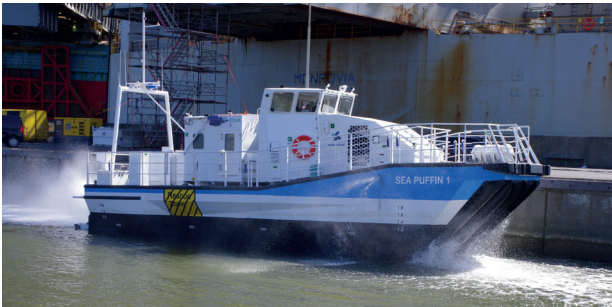
Demonstrasjon: Sea Puffin 1 er en ESNA-SES for offshore vind, og viser her hvordan skipet heves ved hjelp av luftputen. Når viften skrues av vil den sorte delen av skroget være under vann.
