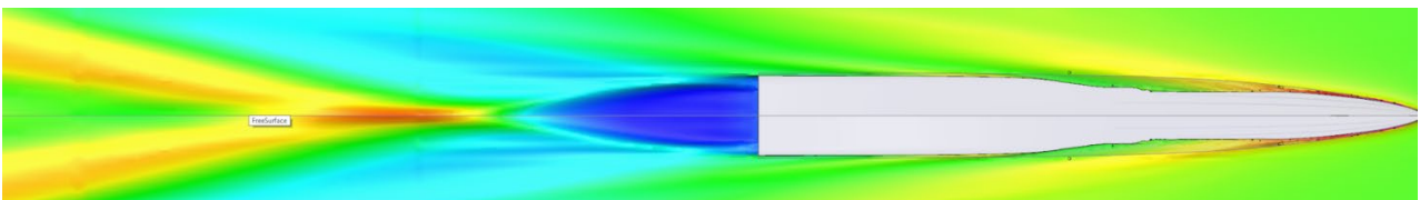
Figur 5.2 - Skrog sett under ifra (strømninger langs skrog)
