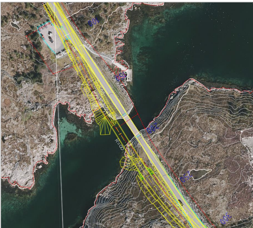
Figur 4-1: Skisse av løsning for ny bru i ny trasé vest for dagens bru.
