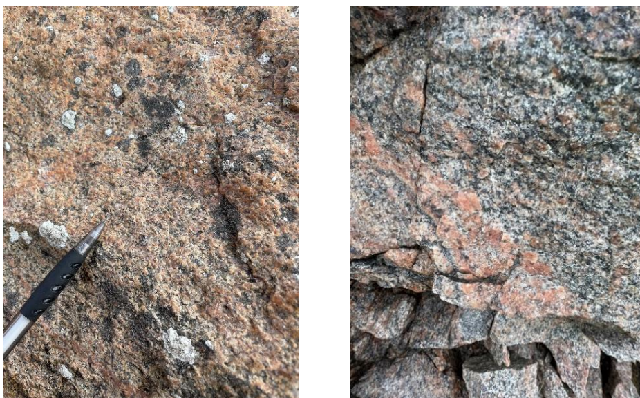
Figur 15: Eksempel på grå og rosa/rødlig granitt som ble observert i hele prosjektområdet.
