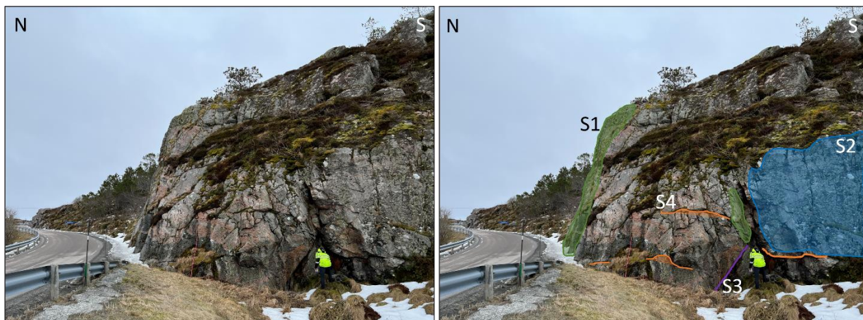
Figur 27: Sprekkesett S1, S2, S3 og S4, samt oppsprukket sone der personen står.
