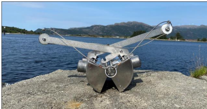
Figur 2-1: Illustrasjon av en van Veen grabb, egnet for prøvetaking av sediment.
