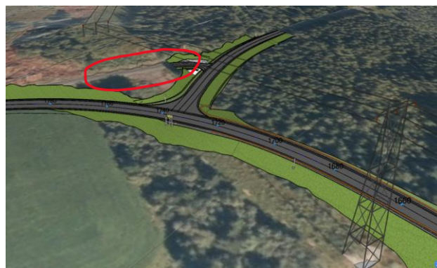
Figur 4-13 T-kryss ved Tjærraverket på Jøa. Bilde til venstre er sett ifra kommunal veg. Bilde til høyre viser krysset i perspektiv. Det ivaretas adkomst til areal avsatt til reindrift, rødt omriss (Kilde: Norconsult).
