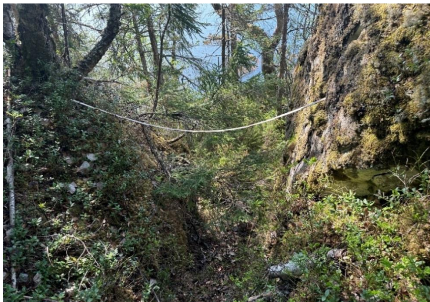
Figur 3-7: Bilde av sone III tatt fra landkantområde og i retning sjøen mot SV. Avstand mellom massivt sideberg på hver side av er ca. 1 m ned mot terrengoverflata. Tommestokk i bildet er 2 meter lang og hviler på massivt sideberg på begge sider av sonen.
