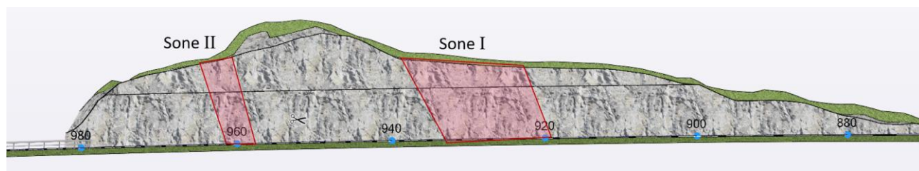
Figur 4-16: Estimert plassering og utbredelse av svakhetssone I og svakhetssone II i høyre side av bergskjæring 2.
