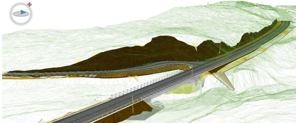
Figur 7.1-1: Oversiktsbilde av skjæringen. Utklipp fra Novapointmodellen. Skjæringen er i fjell, men er modellert opp med farger til jordskjæring da bergmodell mangler.
