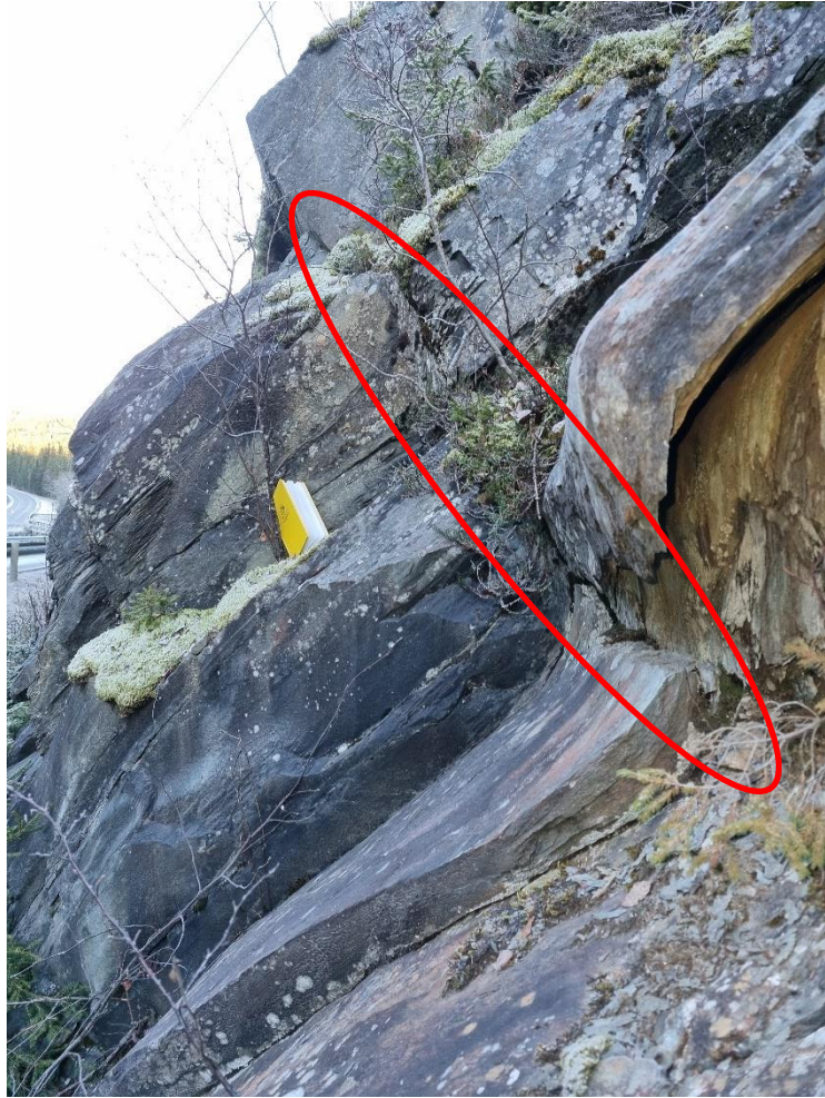
Figur 6.4-3: Nærbilde av grønnskiferen ved befaringslokalitet B03. Bildet er tatt mot nord med gul notatbok for skala. Forkastning er synlig (rød ellipse).
