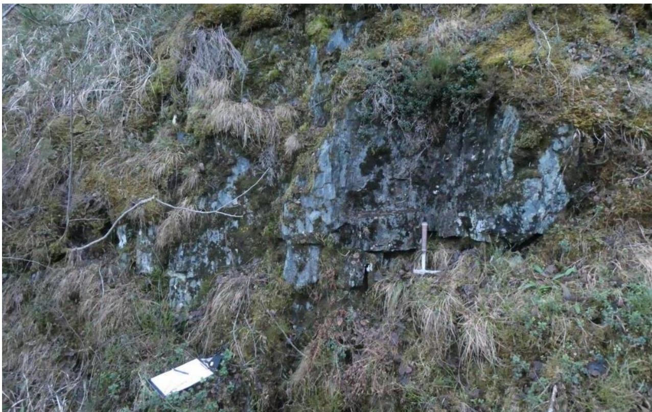
Figur 12: Mørkere, mer skifrig bergart observert rett sør for sørlige avgrensning av skjæring ved Skaret.
