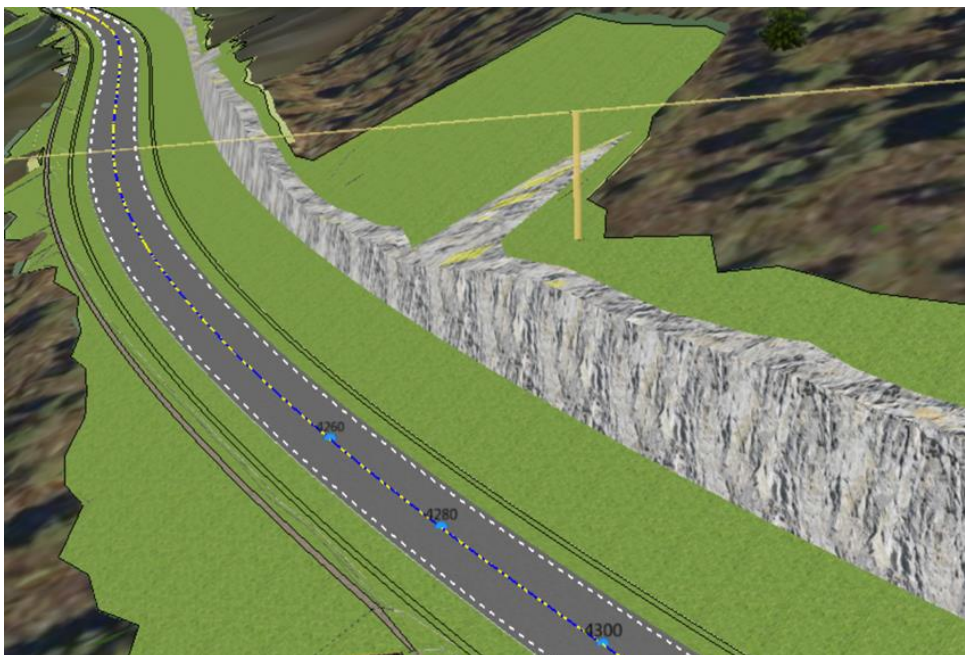
Figur 21: Geometri av bergskjæring ved Skaret ved 4 m ekstra berguttak i grøft samt tilbakefylling. Nærhet til fundament for høyspentmast vises på figuren. Orientering av figuren er mot NØ.
