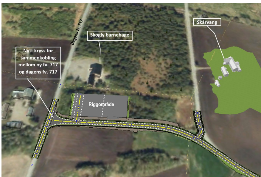
Figur 45: Ny veg og nytt kryssområde for sammenkobling mellom ny fv. 717 og dagens fv. 717. Riggområde ved Skogly friluftsbarnhage.
