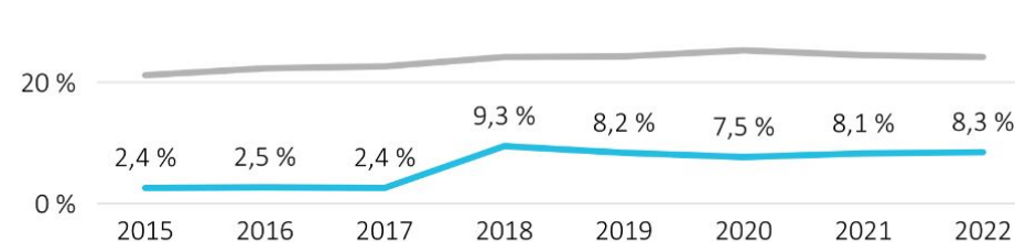
Andel produsert drikkevann som går til spille pga lekkasjer i ledningsnettet
